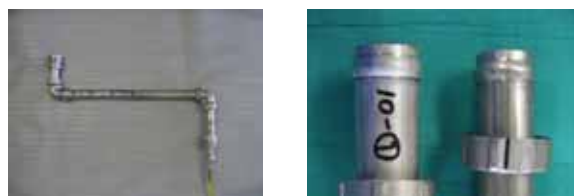
写真-6 回収したメカニカル継手
