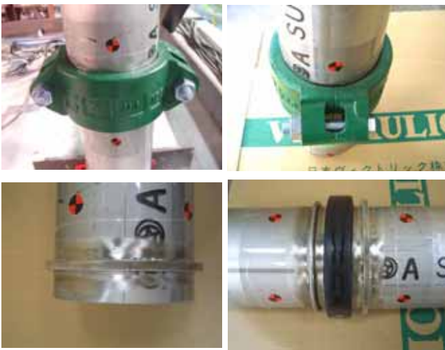
写真-7 回収したハウジング継手
