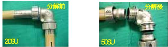
写真9 回収したメカニカル継手
