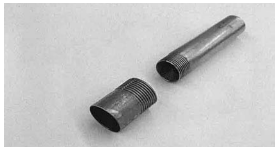
写真-5 転造ねじ (雄ねじ, 雌ねじ)
