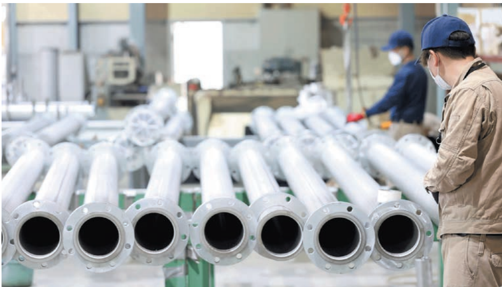
すべての製品が受注生産で、寸法・形状は一品一葉になる。そのため、一つひとつ丁寧な検品作業が求められる（写真上）。配管を接合する際に使う継手部品（写真下）。左が従来品で、右が独自開発の「CFジョイント」。
