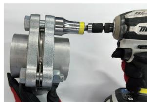
電動式インパクトでの締め付け
