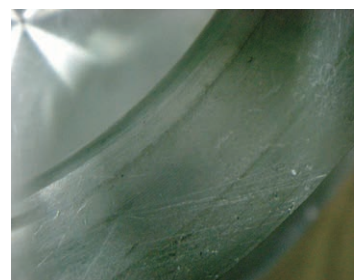
試験後のつば出し管の ガスケットシール面(接写)
