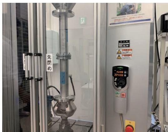
一般配管用ステンレス鋼管 60Su 引張試験
