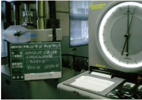
一般配管用ステンレス鋼管 75Su 割りフランジ 引張り試験
