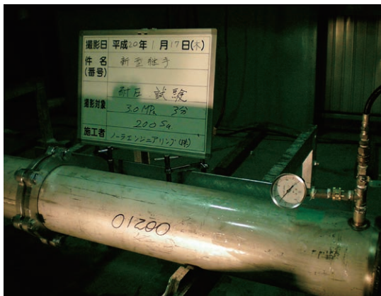
一般配管用ステンレス鋼管 200Su 3.0MPa 耐圧試験
