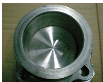
試験後のつば出し管のガスケットシール面
