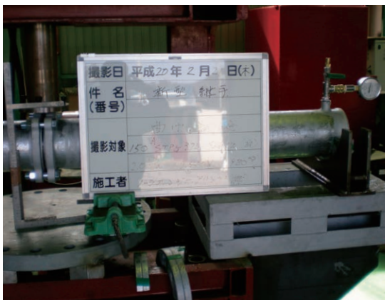
圧力配管用炭素鋼鋼管 STPG370 150A Sch40 2.0MPa曲げ試験
