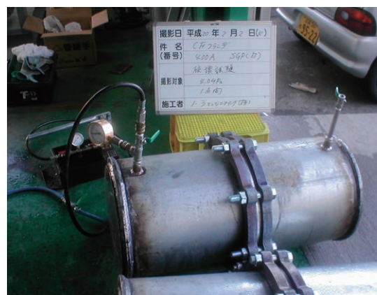
配管用炭素鋼鋼管 SGP 400A 4.0MPa 破壊試験
