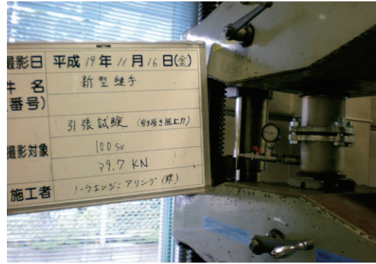
一般配管用ステンレス鋼管 100Su 引張り試験
