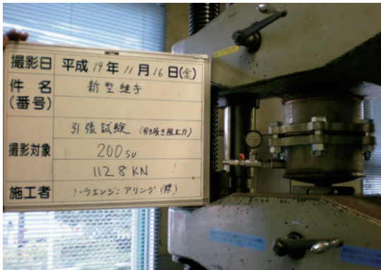
一般配管用ステンレス鋼管 200Su 引張り試験
