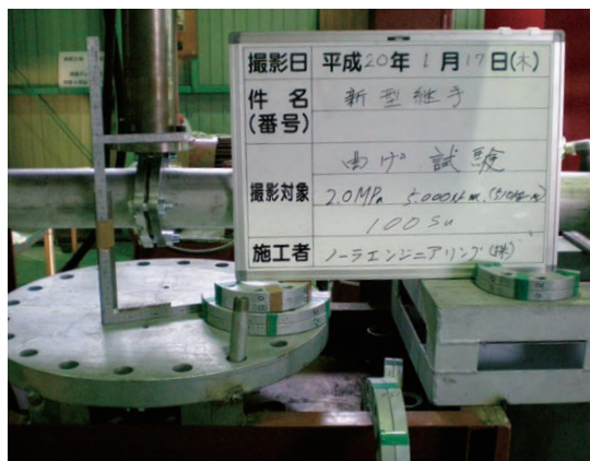
一般配管用ステンレス鋼管 100Su 2.0MPa曲げ試験
