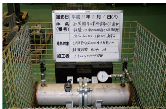
8.0MPa 1分間保持の破壊試験
