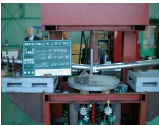
一般配管用ステンレス鋼管 75Su 2.0MPa曲げ試験
