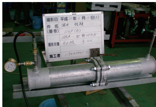
配管用炭素鋼鋼管 SGP 125A2枚重ね割りフランジ 0.1MPa 漏れ試験
