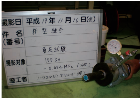
一般配管用ステンレス鋼管 100Su 負圧試験
