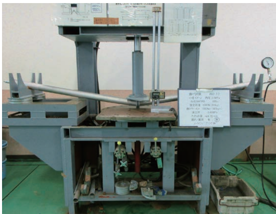
一般配管用ステンレス鋼管 60Su 2.0MPa 曲げ試験
