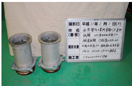
試験体の容積の80%の水と20%エアースペースの状態
