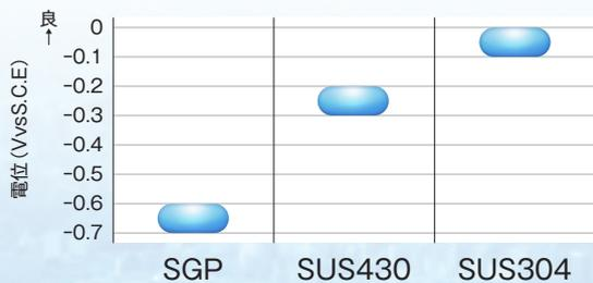
測定条件: 流速2.4~4.0m/s 温度10~17°C
