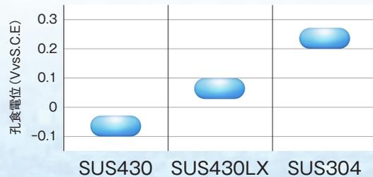
孔食電位 (3.5%NaCl, 30°C Ar脱気中)
