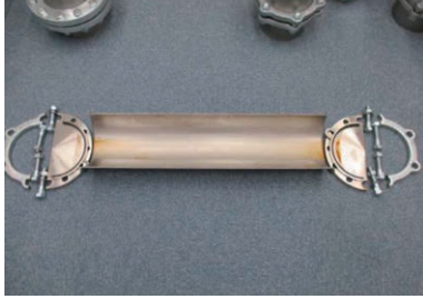
写真3.1 塩化物イオン濃度200mg/L 試験体 3ヶ月腐食試験後の解体状態
