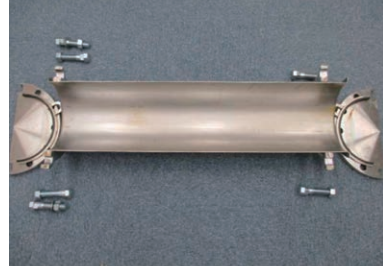
写真3.2 塩化物イオン濃度500mg/L 試験体 3ヶ月腐食試験後の解体状態
