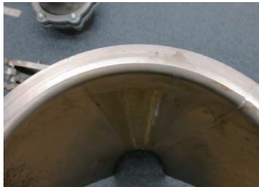
写真3.3 塩化物イオン濃度200mg/L 試験体 右側つば面
